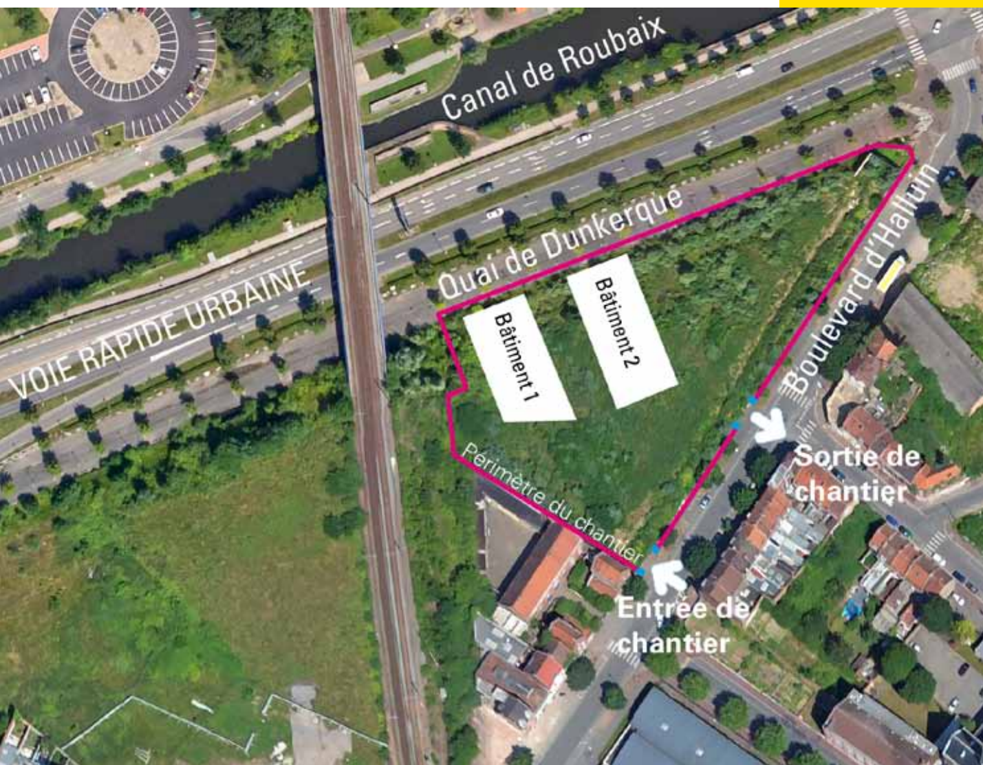
Vue aérienne des Quais de l'Union Emprise des bâtiment et périmètre du chantier
